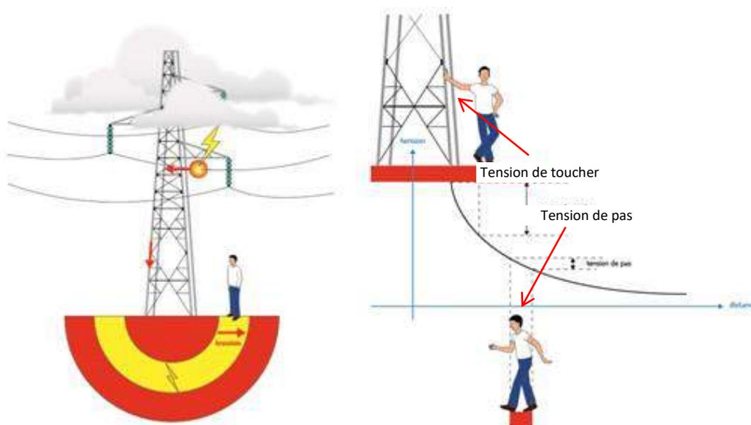
La « tension de toucher » désigne l'électrisation qui peut affecter un opérateur en contact d'une part avec le sol et d'autre part avec une partie conductrice, circuit de mise à la terre ou infrastructure métallique, lors de l'écoulement accidentel d'un courant électrique dans le sol.
