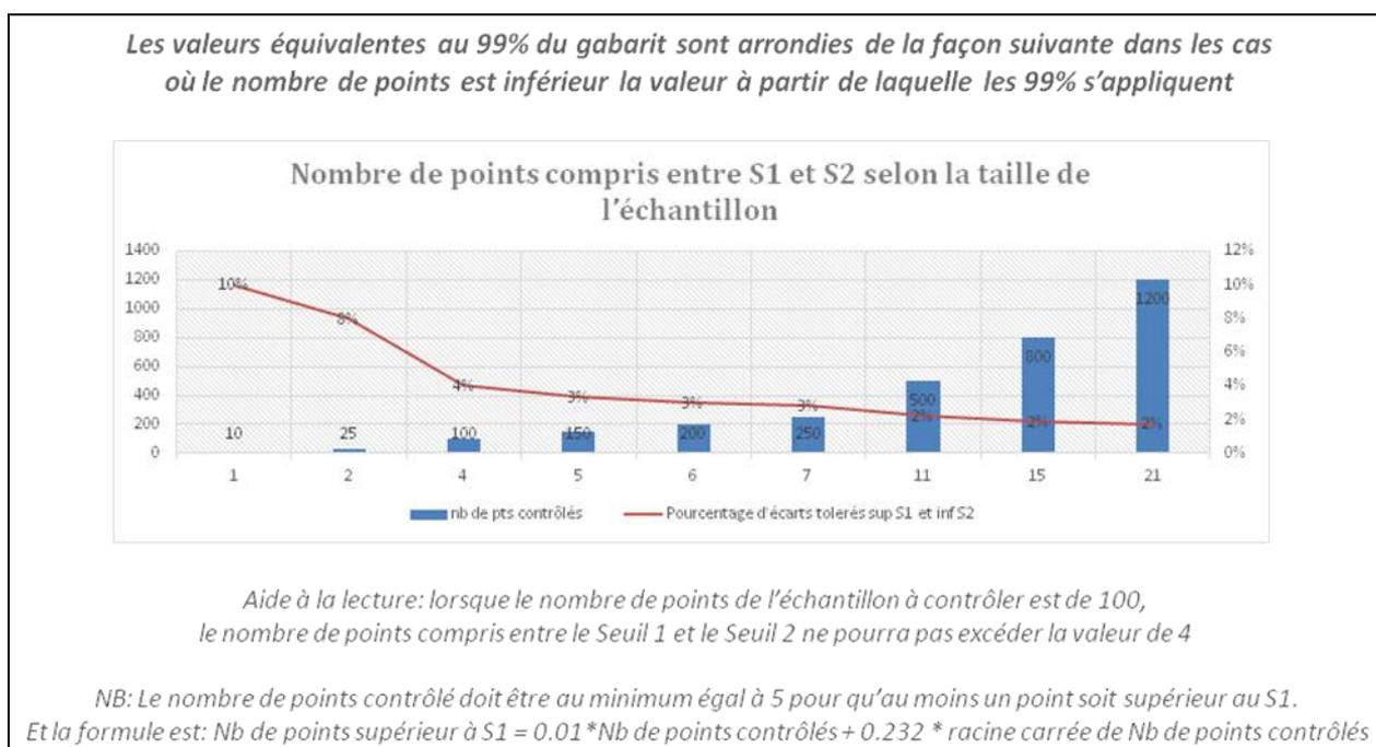
Lorsque les éléments de réseau neufs à récoiler ont été posés avec une technique « sans tranchée », les taux maximaux d'écarts mentionnés dans le tableau 2 ci-dessous s'appliquent.
