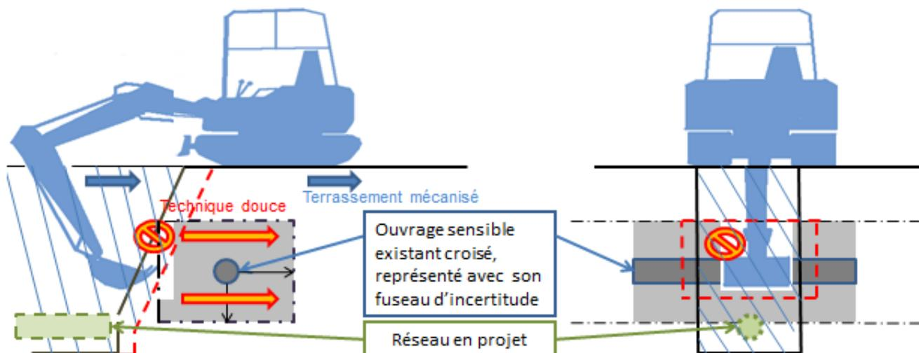
**Chantier mécanisé en croisement d'ouvrage sensible en fouille ouverte.
