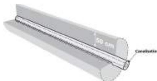
Dans le cas où l'isolation de la canalisation n'est pas en bon état apparent, il faut considérer cette canalisation comme étant une pièce nue sous tension.
