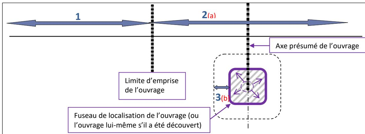
**Zone n°1 (hors emprise de l'ouvrage) :** travail avec des engins mécaniques possible sans la présence de l'exploitant (du transporteur)
