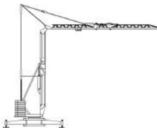
Grue montée à poste fixe ou sur une voie de roulement. Constituée d'assemblage d'éléments, de mâture, de flèche et de contre-flèche.
