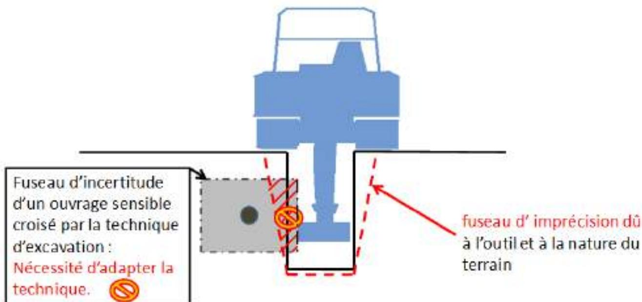
**Chantier mécanisé longeant un ouvrage sensible existant.
