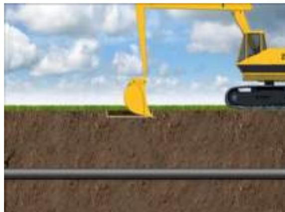
Décroustage des enrobés (chaussée) ou décapage de la terre végétale (champ) parallèlement au réseau après vérification d'une profondeur suffisante du ou des réseaux présents.
