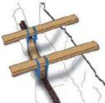
Pour les boîtes à départs multiples dans des directions perpendiculaires, utiliser des sangles placées de façon à éviter tout pivotement de la boîte ou un support permettant le maintien à niveau de l'ensemble. En aucun cas, on ne doit soutenir la boîte par ses câbles.
