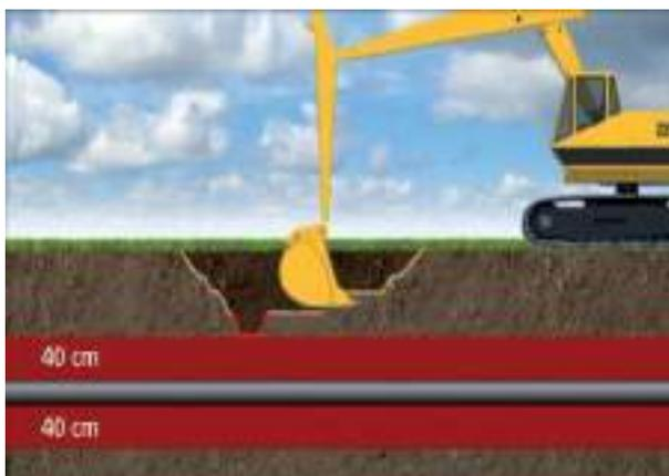
Renouvellement des deux opérations ci-dessus (tranchée manuelle de 30 à 40 cm puis terrassement mécanique de 20 cm) jusqu'à une distance de 40 cm de l'ouvrage
